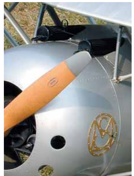
A sinistra: trittico dell'aereo, reperito da Scale Model Research, sito internet http://imt.net/~ims/scale.html . Sopra: in primo piano, il marchio di fabbrica e le mitragliere. Sotto: nell'ampia naca trovano comodamente posto, oltre al Saito 120S, il riduttore Byron, il serbatoio ed una batteria Cyclon per la candela.
