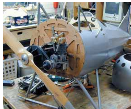
A sinistra: trittico dell'aereo, reperito da Scale Model Research, sito internet http://imt.net/~ims/scale.html . Sopra: in primo piano, il marchio di fabbrica e le mitragliere. Sotto: nell'ampia naca trovano comodamente posto, oltre al Saito 120S, il riduttore Byron, il serbatoio ed una batteria Cyclon per la candela.
