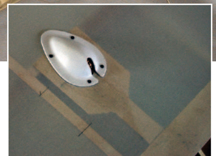
Die Anlenkung der Querruder erfolgt durch Seile, die über Umlenkrollen nach außen geführt werden – dem echten Flugzeug nachgeahmt, funktioniert das sehr gut. Über die Umlenkrollen kommen vorbildgetreue Abdeckungen.
