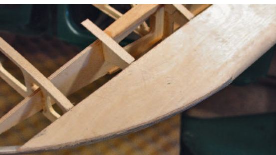
Die Randbögen sind aus Edelstahlrohren gebogen und teilweise mit 0,8-mm-Birkensperrholz beplankt.
