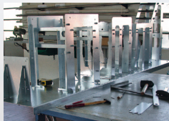
Für das verzugsfreie Löten des Edelstahlrohrumpfes wurde eine Helling aus lasergeschnittenen Blechen gefertigt.
