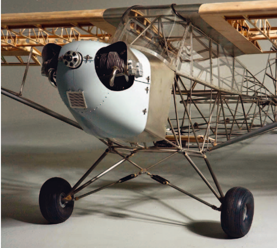
Der Rohbau steht – die teilbare Motorhaube besteht aus GFK, die Verkleidungen aus lasergeschnittenen Alu-Blechen.
