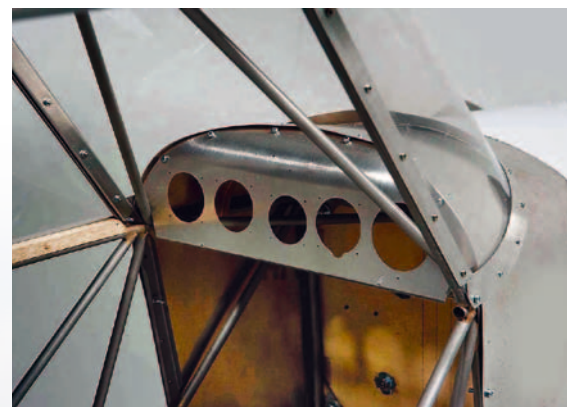
Das Instrumentenpaneel im Rohbaustadium
