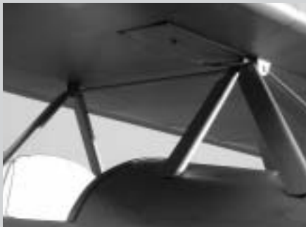
Auf der Flächenunterseite finden wir diese Serviceklappe, um später nach Zusammenstecken der Flächen an die Steckverbindung der Servokabel heranzukommen
