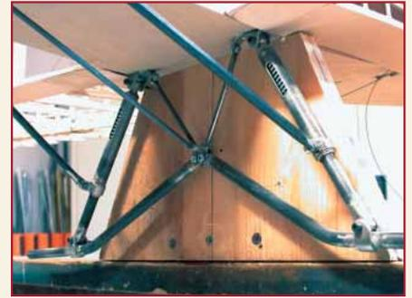
Das Fahrwerk ist aus Chrom-Molybdän-Rohren hart verlötet, die Federung übernehmen Gummielemente
