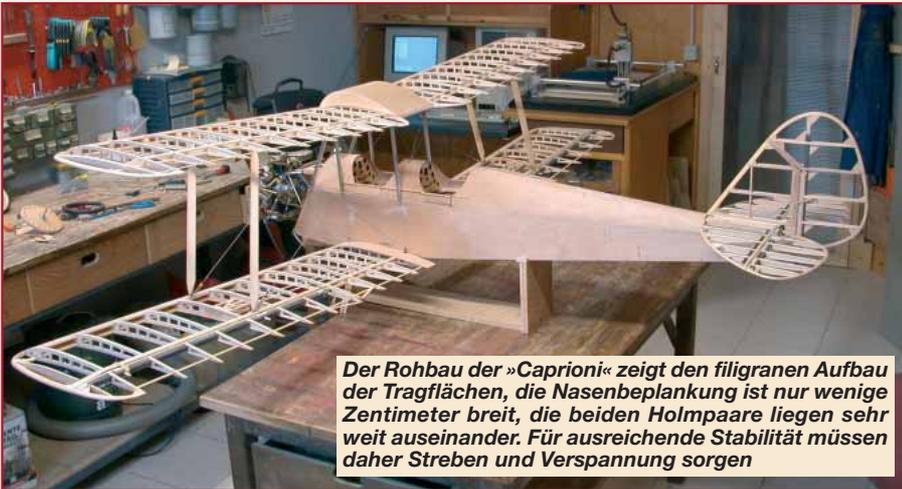
Der Rohbau der »Caprioni« zeigt den filigranen Aufbau der Tragflächen, die Nasenbeplankung ist nur wenige Zentimeter breit, die beiden Holmpaare liegen sehr weit auseinander. Für ausreichende Stabilität müssen daher Streben und Verspannung sorgen
