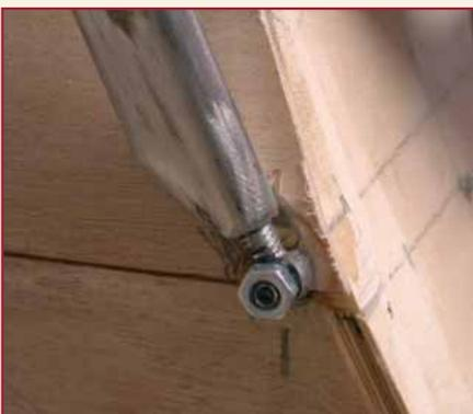
Demontierbar: Auch die Streben des sehr hoch über dem Rumpf sitzenden Baldachins sind schraubbar ausgeführt
