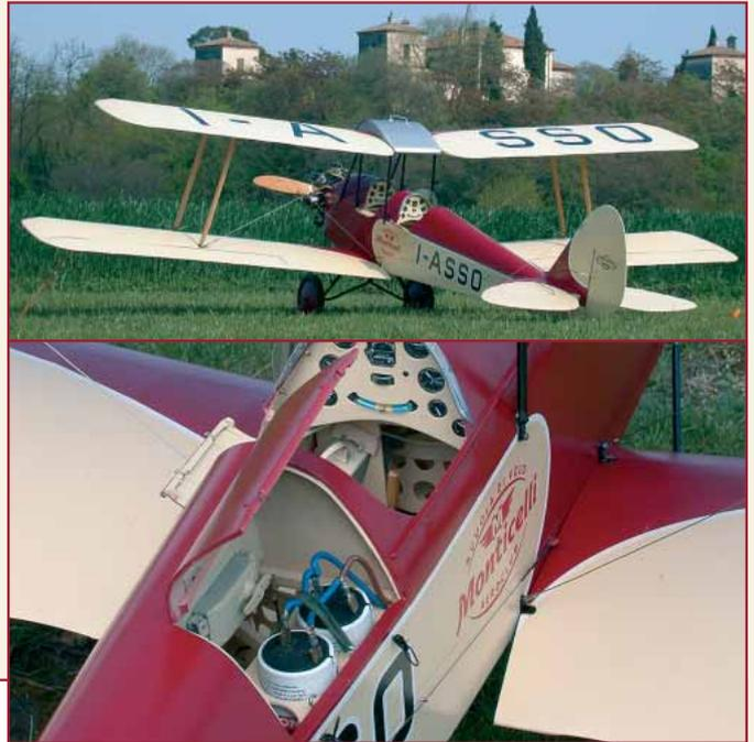
**Powerstromversorgung: diesmal nicht für die Servos, sondern für die 7 Glühkerzen des Sternmotors**
