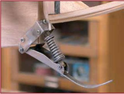
Es sind die kleinen Details, die einen beim Bau eines Scale-Modells auf Trapp halten. Der Schleifsporn ist wie beim Vorbild sogar gefedert ausgeführt
