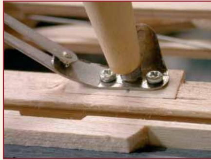
Um den Aufbau zu erleichtern, werden die Streben in diese Blechbeschläge eingesteckt. Anschließend werden die Verspannungen über Gabelköpfe eingehängt
