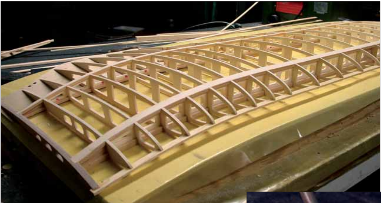
Sopra: l'ala superiore in costruzione sull'apposito piano curvo. A destra: gli attacchi dei montanti.
