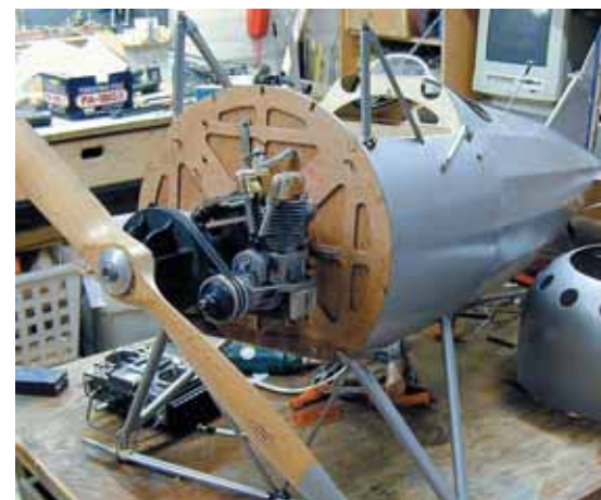
A sinistra: tritico dell'aereo, reperito da Scale Model Research, sito internet http://imt.net/~ims/scale.html . Sopra: in primo piano, il marchio di fabbrica e le mitragliere. Sotto: nell'ampia naca trovano comodamente posto, oltre al Saito 120S, il riduttore Byron, il serbatoio ed una batteria Cyclon per la candela.
