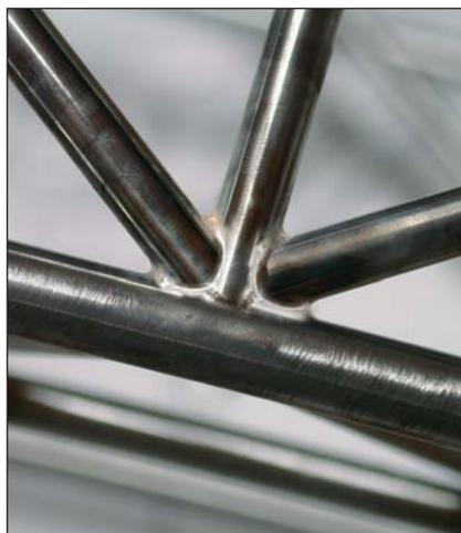
va ancora impiegata in aeromodellismo, né tantomeno aveva prodotto kit di questo tipo in serie, essendo difficile reperire a costi accettabili il tipo di tubo adatto. La fusoliera è in tubi di acciaio inox da 3, 4, 5, e 6 mm di diametro con spessore di 2,5 decimi, prendendola in mano ci si rende conto di quanto sia robusta e indeformabile. La struttura riproduce fedelmente l'originale e pesa meno di 700 grammi, le saldature sono in lega d'argento.
