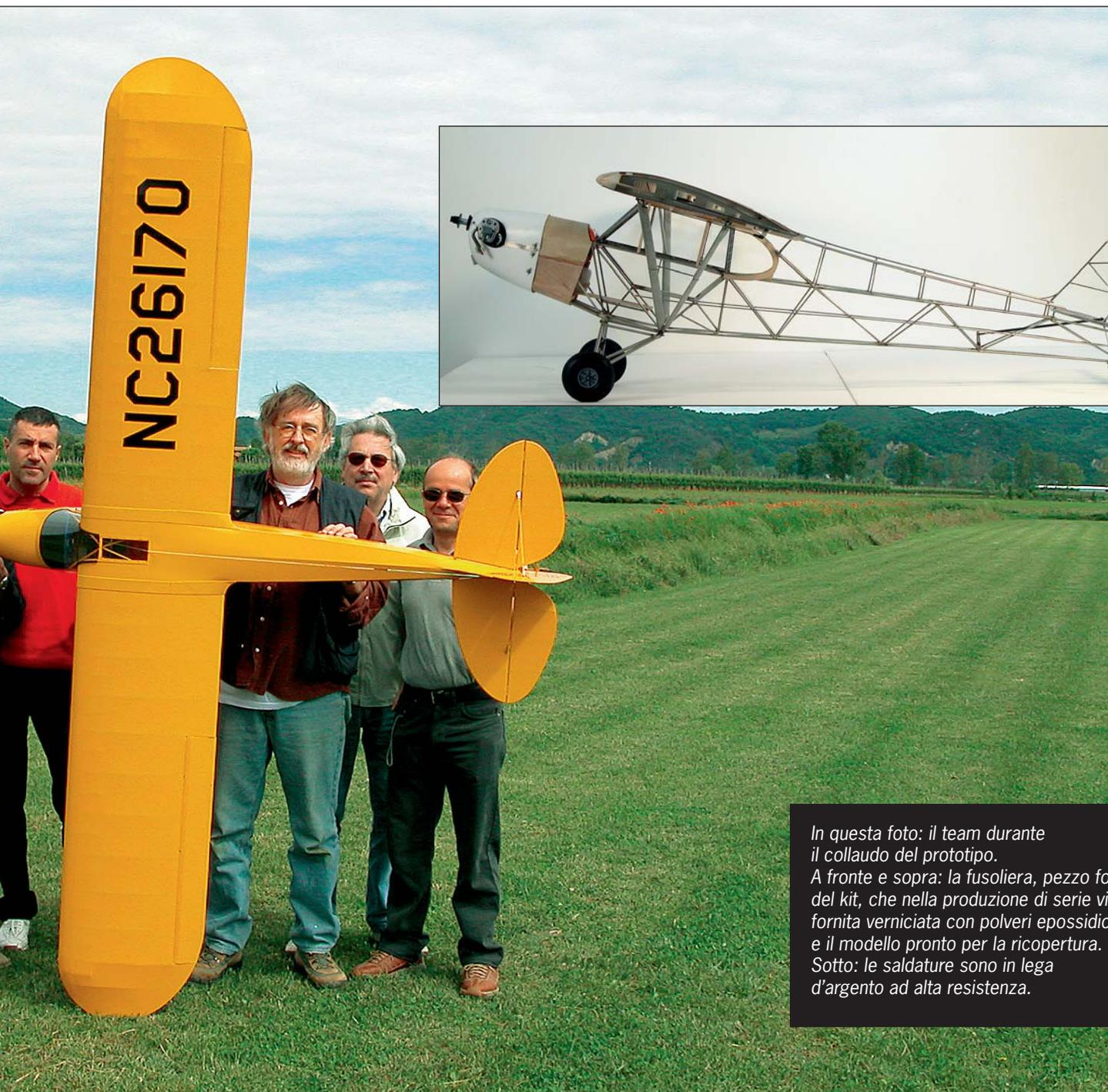
*In questa foto: il team durante il collaudo del prototipo. A fronte e sopra: la fusoliera, pezzo forte del kit, che nella produzione di serie viene fornita verniciata con polveri epossidiche, e il modello pronto per la ricopertura. Sotto: le saldature sono in lega d'argento ad alta resistenza.*
