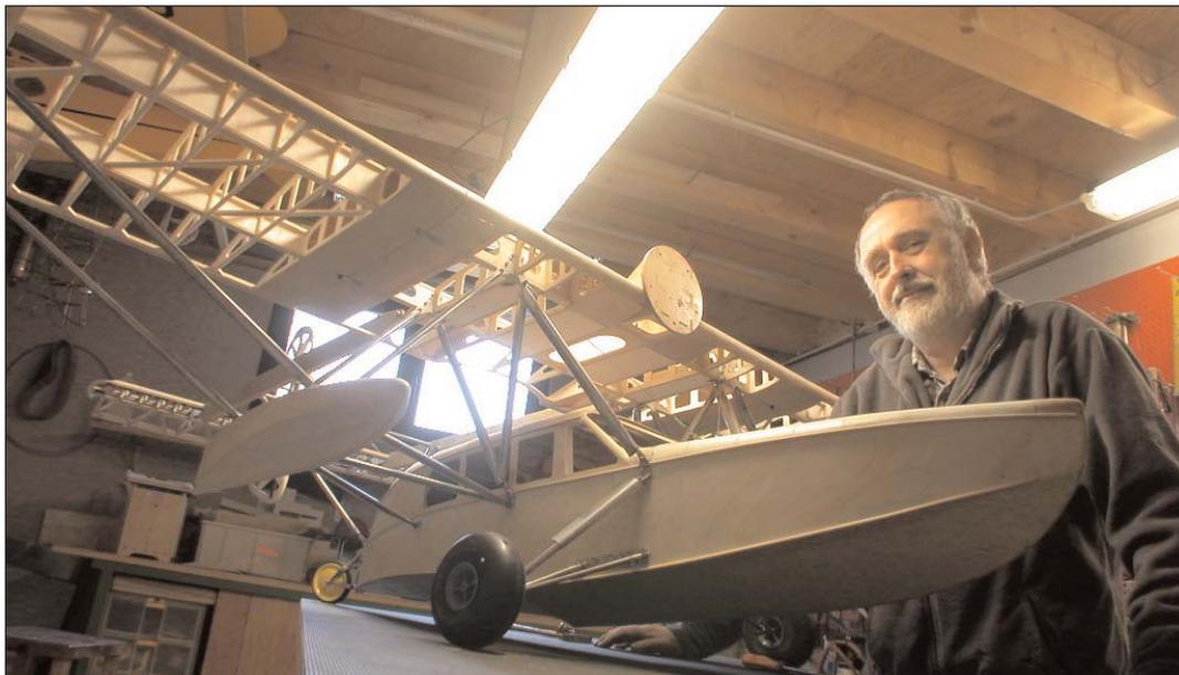
betulla nei punti di maggior sforzo e sono chiusi da due fiancate in compensato di betulla da 0,8 mm. Erano così anche quelli del vero aereo. Sono fissati con due cerniere in acciaio inox alle centine in betulla da 5 mm già citate. Sono inoltre supportati da due montanti inox fissati in prossimità del ruotino di coda. La rigidità strutturale è assicurata da doppi tiranti incrociati in acciaio inox da 1 mm che suo-
