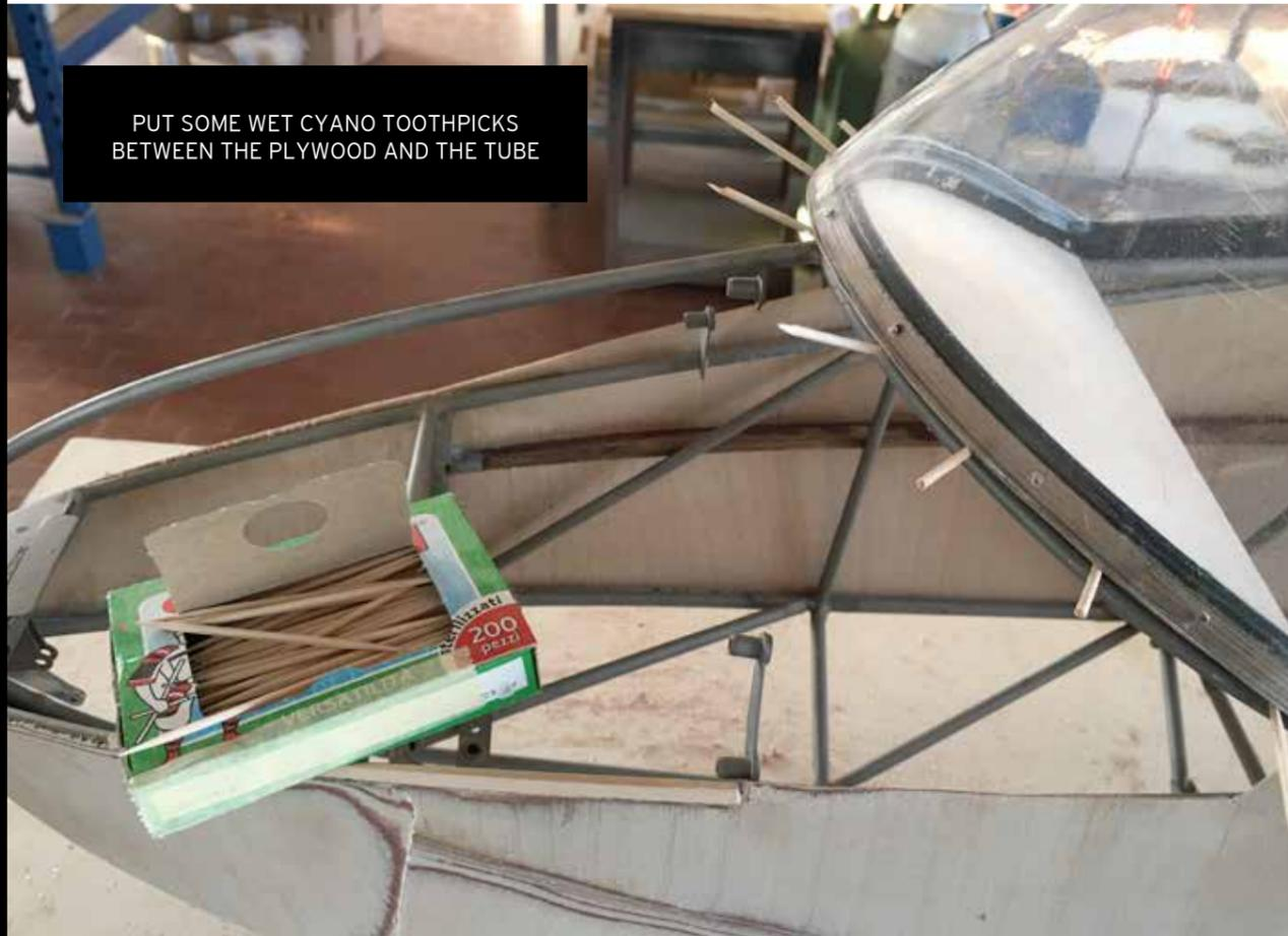
PUT SOME WET CYANO TOOTHPICKS BETWEEN THE PLYWOOD AND THE TUBE
