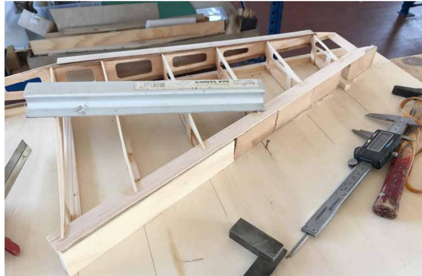
PLACE A 36 MM WIDE STRIP UNDER THE TRAILING EDGE FOR SUPPORT AND SAND THE Balsa TRAILING EDGE
