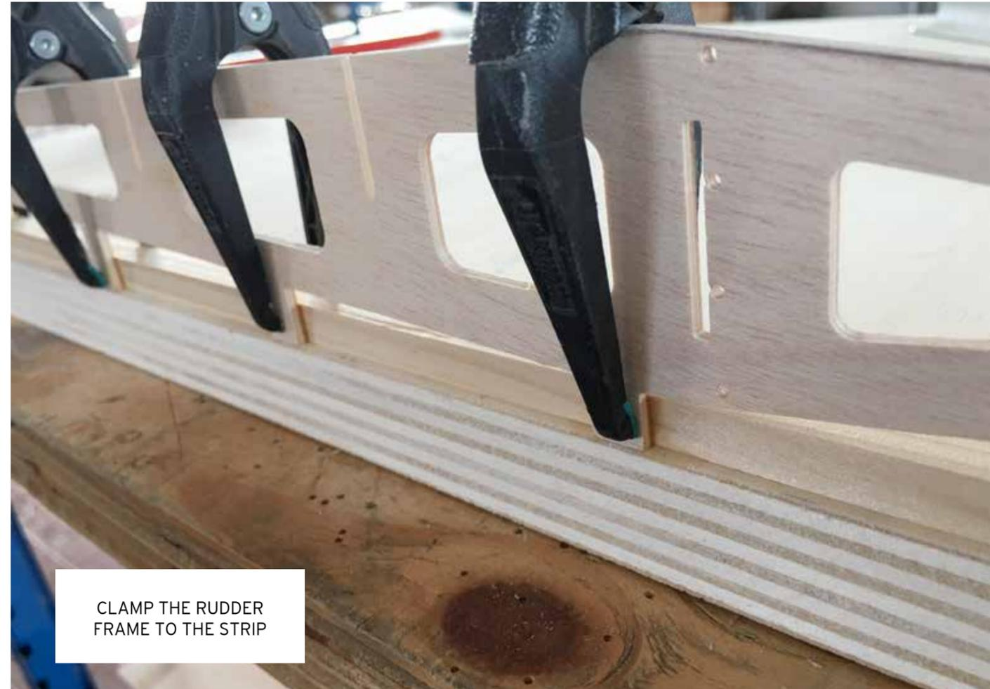
CLAMP THE RUDDER FRAME TO THE STRIP
