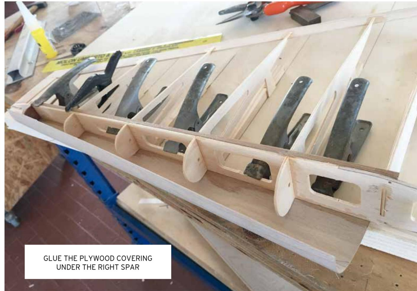
GLUE THE PLYWOOD COVERING UNDER THE RIGHT SPAR
